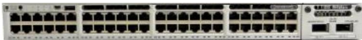
Obrázek č. 17 Přední pohled na agregační L3 přepínač C9300-48T-A s modulem C9300-NM-2Q
