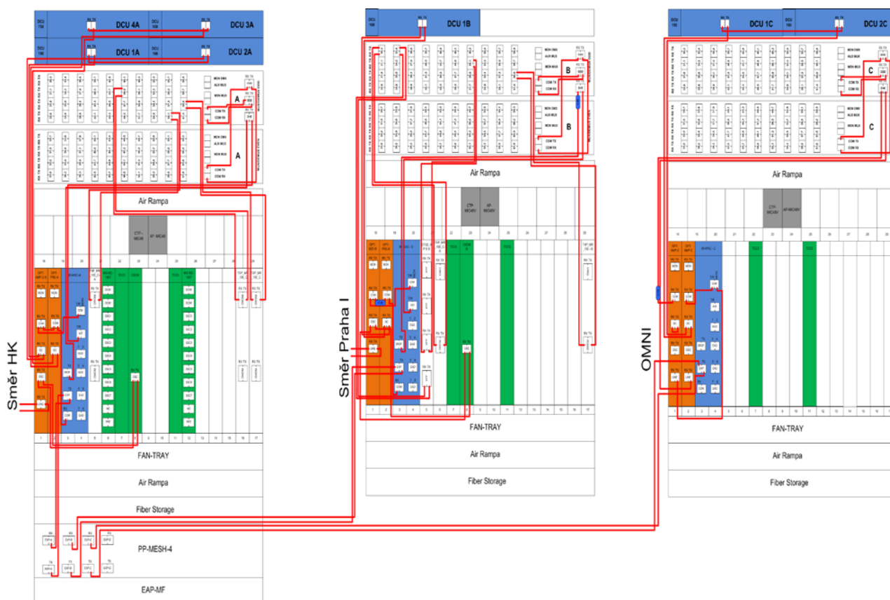
Obrázek 3 Konfigurace a zapojení DWDM uzlu Praha_2
