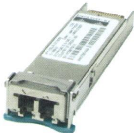
Obrázek: Optický modul XFP se sníženou spotřebou 1,5W
